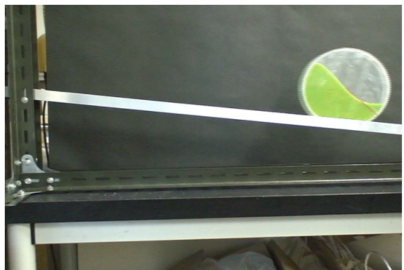
図 2. 斜面角度 \theta = 8.4^\circ の場合の斜面形状 (パターン II)
