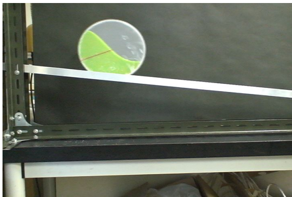
図 2. 斜面角度 \theta = 8.4^\circ の場合の斜面形状 (パターン II)
