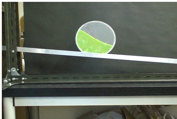
図 1. 斜面角度 \theta = 5.5^\circ の場合の斜面形状 (パターン I)
